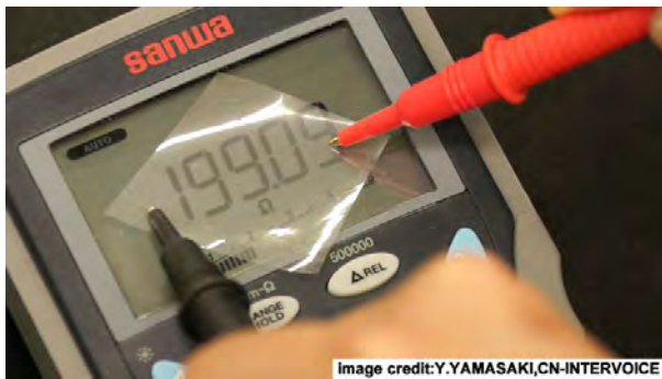
図4 銀ナノワイヤを塗布した導電性透明ナノペーパー
