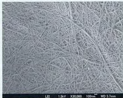
図1 カニ殻から単離されたキチンナノファイバーのSEM像
