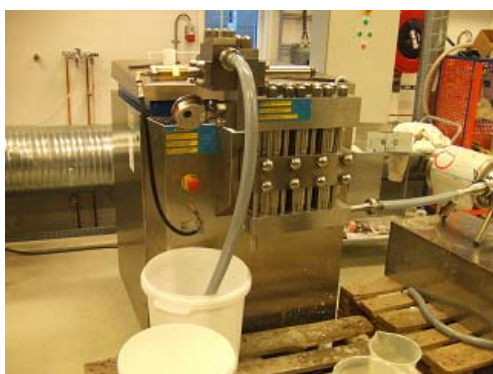
高圧ホモジナイザSPX製(デンマーク) 処理量: 200g/hで濃度1%
