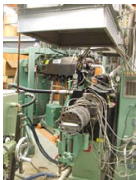
2軸混練機(木質材料の作成に使用)
