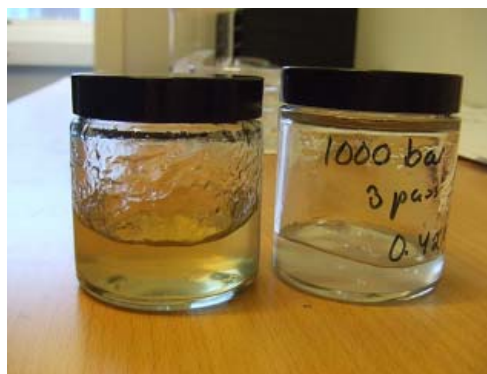
カルボキシメチル化CNF(ホモジナイザ) 左: 未漂白、右: 漂白パルプを使用 濃度0.46%、3パス、1000Bar、透明/ゼリー状
