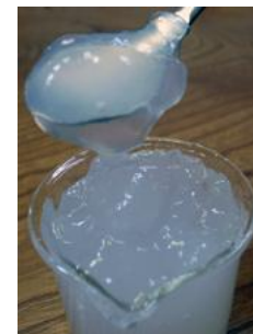
木材から単離した幅15nmのセルロースナノファイバー（左）と1wt%水懸濁液（右）
