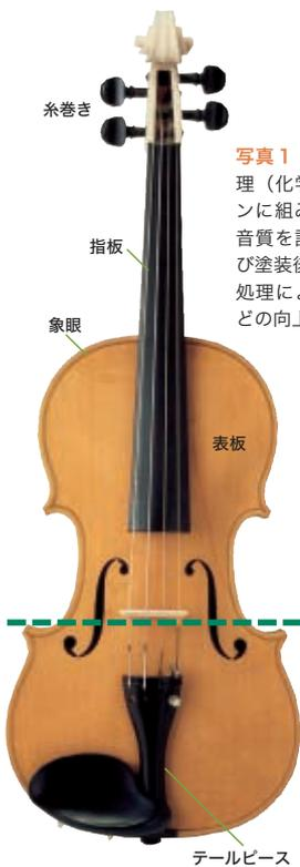
写真1 ホルムアルデヒド処理(化学処理)後にバイオリンに組み上げ、塗装の前で音質を評価した。塗装前および塗装後、いずれにおいても、処理による音のつや、響きなどの向上が認められた。
