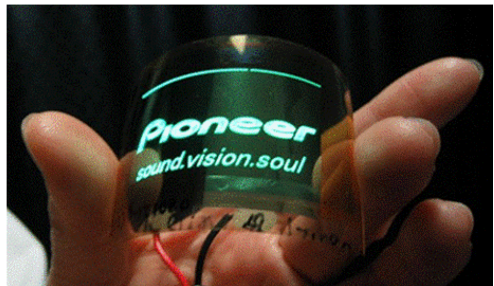
セルロースナノファイバー透明基板上で発光させた有機EL素子 (矢野ら、2007)
