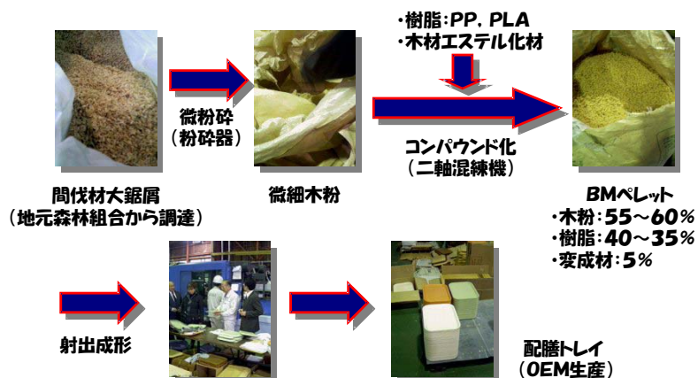
図 2.2.3 バイオマス変性系資材(アグリフューチャー・じょうえつ(株)開発)
