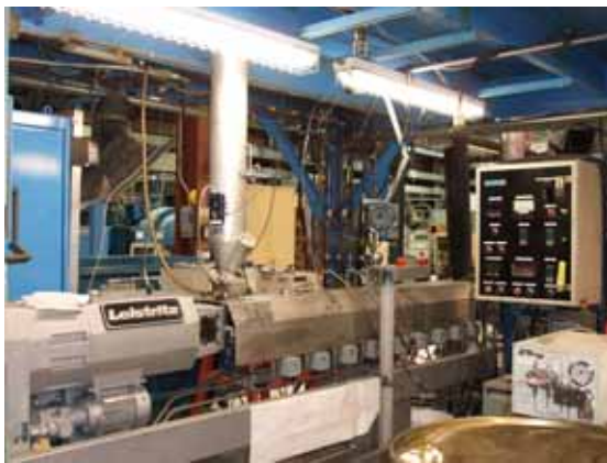
写真4 軸径45の2軸混練機
