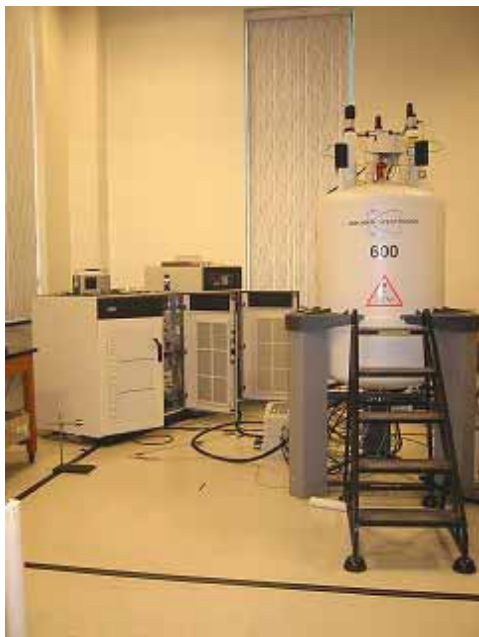
写真 5 分子構造解析用 600G 型 NMR
