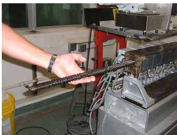
写真 3 ナノファイバー分散用小型 2 軸押し出し機
