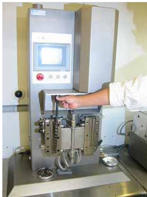
写真 2 熱可塑性樹脂へのナノファイバー分散のための循環式2軸押し出し機(DSM社製)
