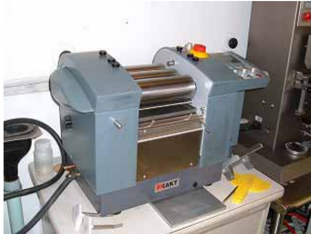
写真 1 液状樹脂へのナノファイバー分散のための3本ロール
