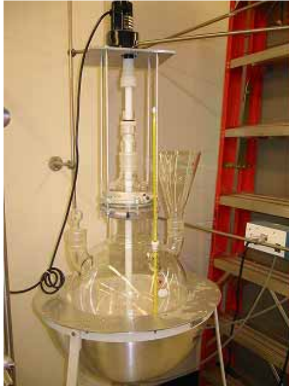
写真 2 セルロースナノファイバー作製用 2.2L 容反応装置
