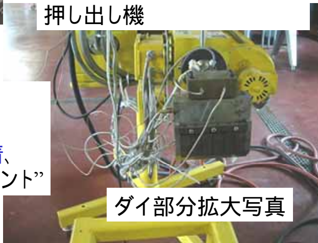
小型2軸押し出し機(ストランド)
