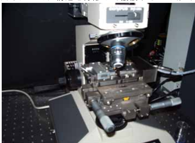
写真 3 引っ張りステージ付属ラマン散乱装置
