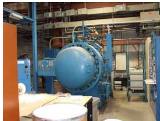
写真7 オートクレーブ
