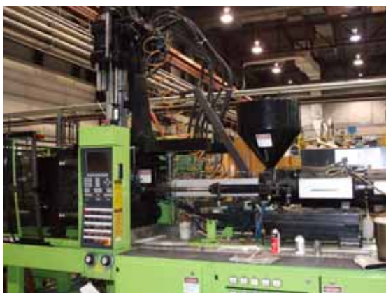
写真6 型締圧120tの射出成形機
