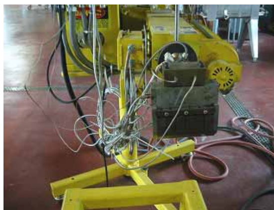
写真 4 フィルム作製用 T 型ダイ付き押し出し機(左:全体像、右:ダイ部分拡大写真)
