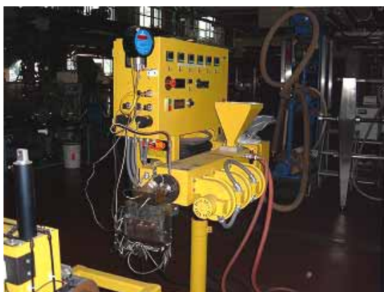
写真 4 フィルム作製用 T 型ダイ付き押し出し機(左:全体像、右:ダイ部分拡大写真)
