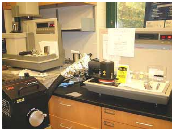
写真 6 熱分析装置 (DSC, TMA)
