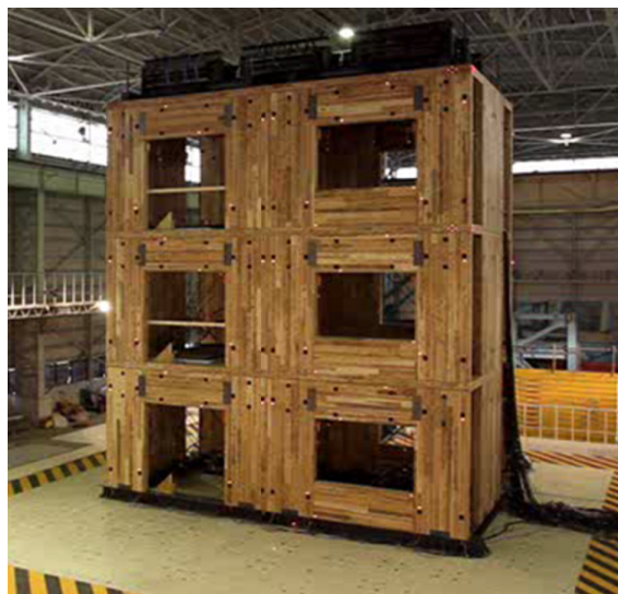
写真2 CLTを用いた構造の振動台実験
