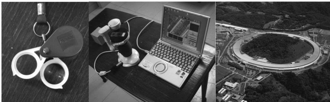
図4 木材を観察するいろいろな道具。(左) ルーペ。サンプルの大きさを問わず、非破壊で表面観察できる。しかし倍率は20倍程度に留まり、木材の解剖学的な特徴をすべてみることはできない。(中) デジタル顕微鏡。持ち運びが可能で光学顕微鏡でみることのできる特徴が観察可能。フィールド調査に便利。ただし、プレパラート切片が必要であり、試料の破壊はさけられない。(上) 大型放射光施設 SPring-8。蓄積リング内を光のスピードに加速された電子から制動放射されたX線を利用して研究を行う施設。リング内にいくつもの実験室があり、その中に、CT専用の部屋がある。サンプルの大きさは制限があるものの（1ミリメートル以下）、1マイクロメートルを切る解像力がある。
