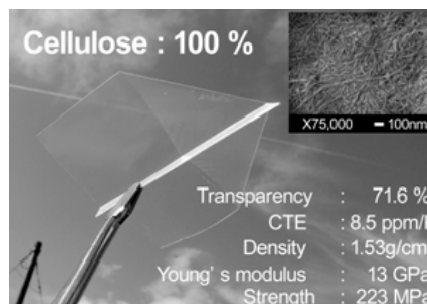
図4：100%セルロースナノファイバーで出来た透明材料
