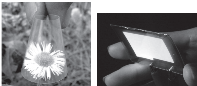
図 7 セルロースナノファイバー補強透明材料 (左) とセルロースナノコンポジットを透明基板に用いた有機 EL 発光素子 (右)
