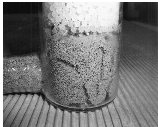
図8：ガラスビーズの貫通試験(シロアリは下部の土壌中で蟻道をつくって活動しているが、上部のガラスビーズには侵入できない) 提供：築瀬佳之
