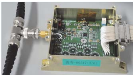
平成24年度に開発した電界用プリアンプのBIM.
