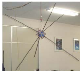
開発した自己伸展型電界アンテナをもつ 小型センサーノードの構造モデル.
