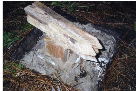
図1：17年度に設置し、18年度に移設した防蟻束コントロール試験体の状況（2年半経過）。昨年の観察と比較して、蟻道が一層拡大している。
