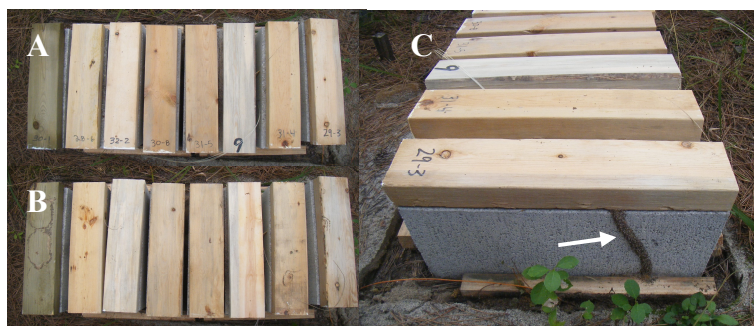
写真 1 ボックス番号 9 の試験体 A: 試験体上面 B: 試験体下面 C: コンクリートブロック外面上の蟻道(矢印)
