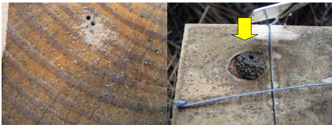
図：マツ餌材の食害痕とクモトオシ辺材の付着物
