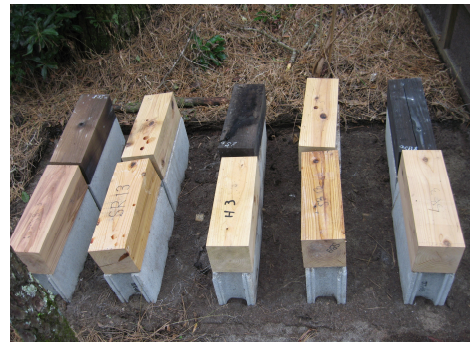
図-1 土台角の設置状況
